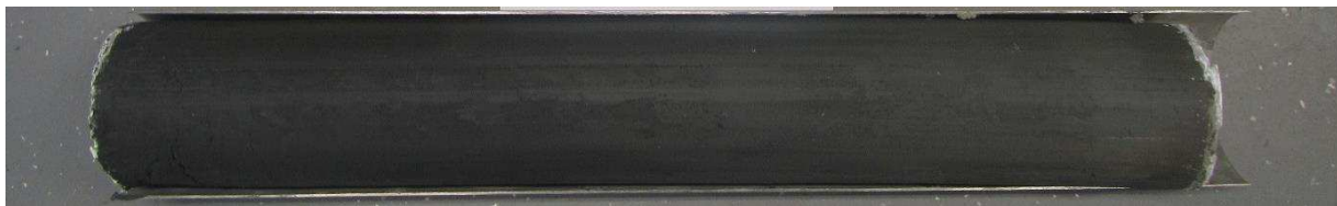
Rys. 3 Próba o nienaruszonej strukturze z OTW 8 13,1-13,7m po wyciśnięciu z próbnika Widoczne ślady zabezpieczeń przed wysychaniem na końcach próby
